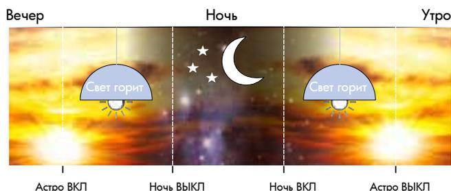
**Смещение:** Для астрономического времени дополнительно можно настраивать также смещение по времени. Благодаря этой настраиваемой временной разнице коммутация таймера может выполняться соответственно ДО (BEFORE) или ПОСЛЕ (AFTER) рассвета/заката или, при нулевом значении смещения, непосредственно в момент рассвета/заката.
